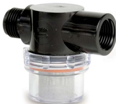
Ce filtre est adapté pour être utilisé avec des pompes de surface SHURFLO des gammes 8000 / 2088 / 5030 / 5040 et 5050. Il est lavable. Il est à monter sur le côté aspiration de la pompe et est adapté pour être utilisé avec le kit d'aspiration avec crépine (référence M31112).
