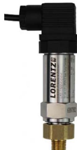
Le capteur de pression mesure la pression dans une canalisation ou dans un réservoir. Cette mesure avec un contrôleur LORENTZ permet d'éteindre et d'allumer la pompe à une certaine valeur de pression ou de garder une pression constante dans l'installation.
